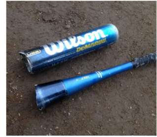
写真3 折れた金属バット
